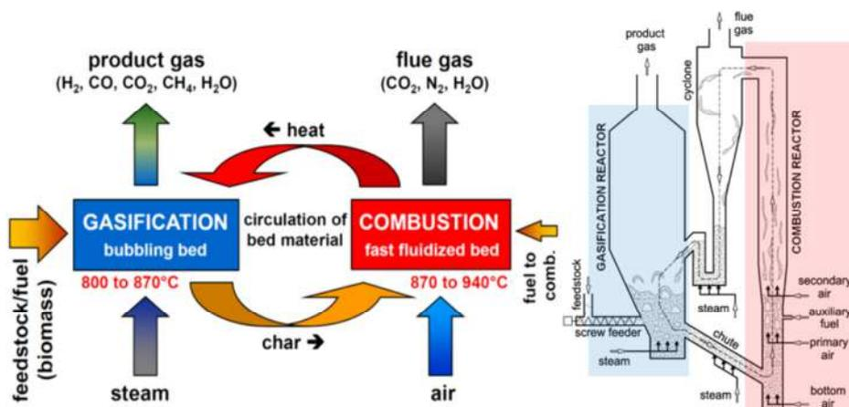
Abbildung 1: Funktionsprinzip der DFB-Vergasung<sup>4</sup>
