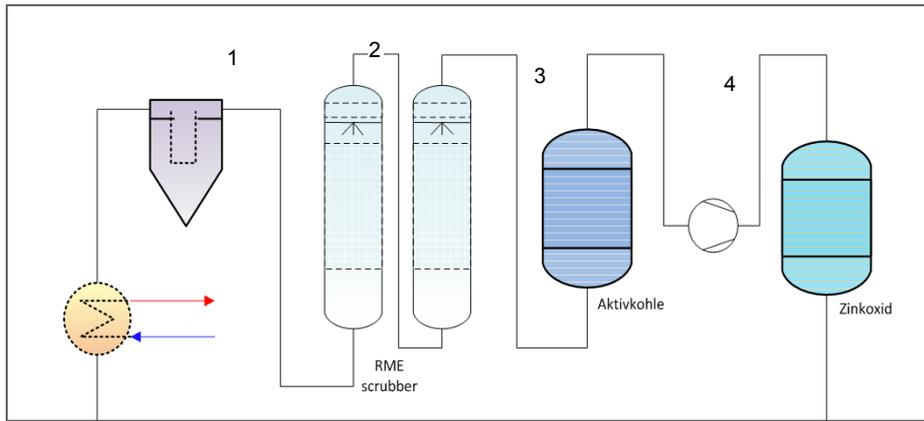
Abbildung 5: Prozesskette Gasreinigung: 1.Filter, 2.RME Wäscher, 3. Aktivkohle, 4. Zinkoxid
