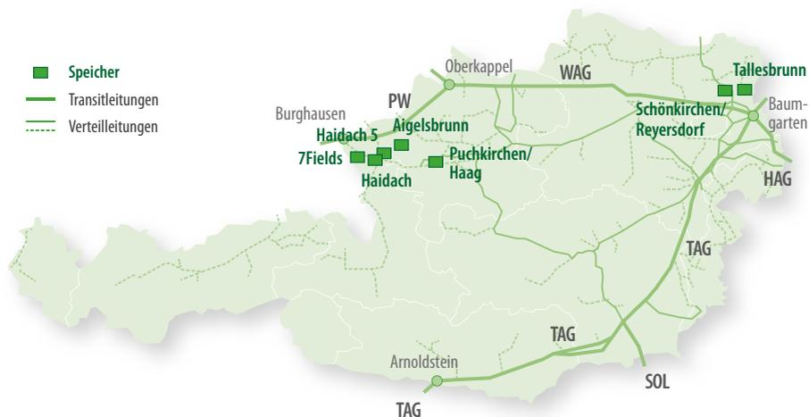
Das österreichische Gasnetz: über 45.000 km Leitungen sowie unterirdische Speicher mit einer Kapazität von mehr als 8 Mrd. m<sup>3</sup>
